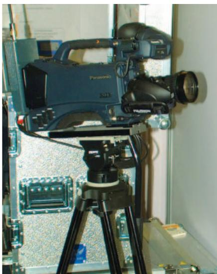
Система Video Link, установленная на камере
