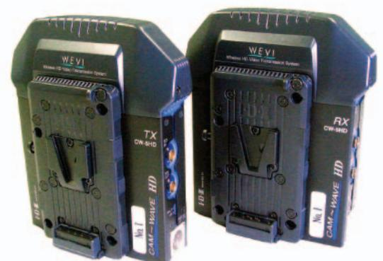
Передатчик и приемник CW-5HD
